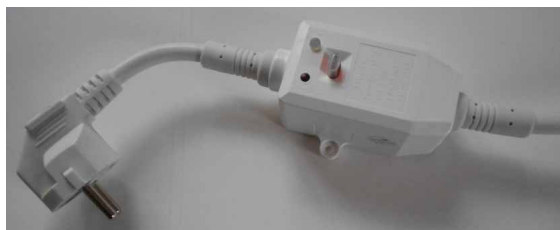
Rys. 24. Widok zabezpieczenia różnicowo-prądowego zamontowanego na kablu zasilającym.
